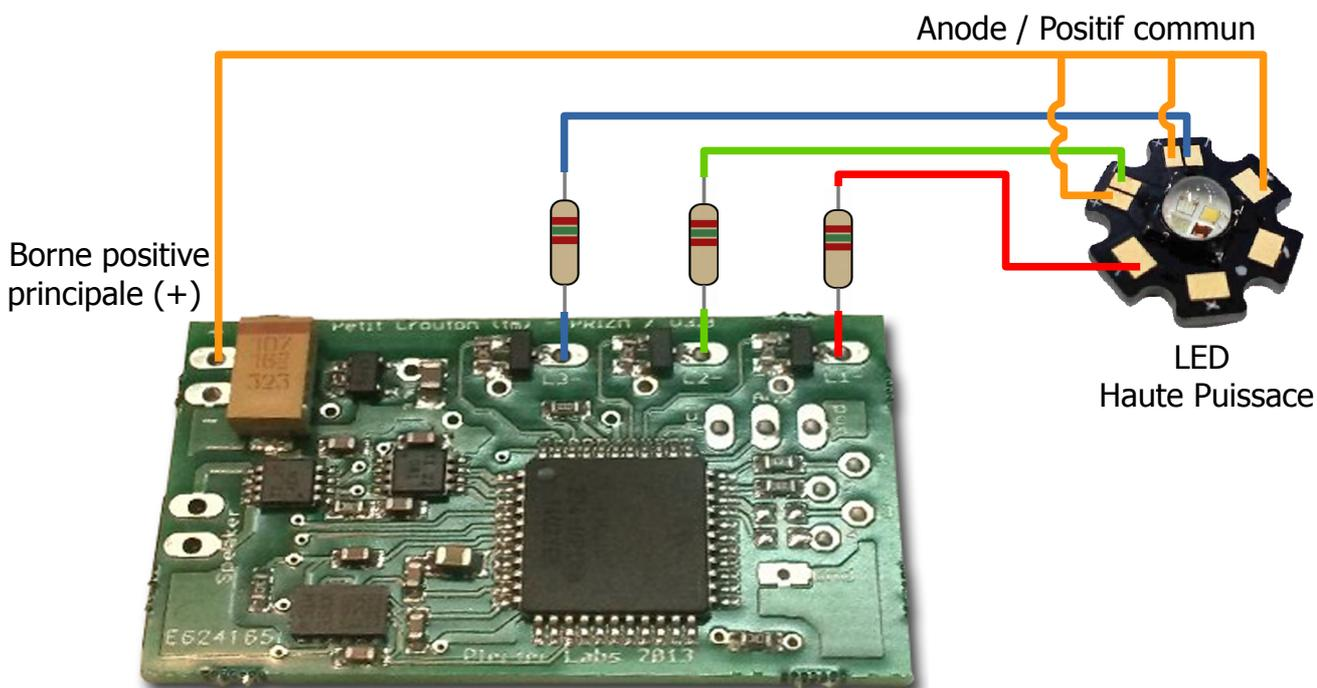
L'exemple ci-dessus montre une LED Haute Puissance avec des puces indépendantes. Les Anodes des puces sont câblées ensemble.
