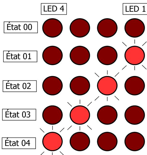
Le durée entre chaque état peut être différent pour chaque ligne "État", il n'est pas nécessaire d'avoir un modèle avec un timing constant. Une valeur de **0** pour une ligne "durée" arrêtera le séquenceur. Par conséquent, il est possible d'avoir une animation de LED décoratives lorsque le sabre commence, et l'animation peut s'arrêter à la fin de ces 32 étapes, ou avant, quand une durée «0» se trouve dans le fichier.
