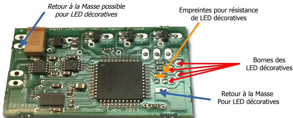
Pour minimiser l'espace le PC intègre les emplacements pour les résistances CMS (Composant Monté en Surface). L'emplacement est fait pour les résistances de type 0603.
